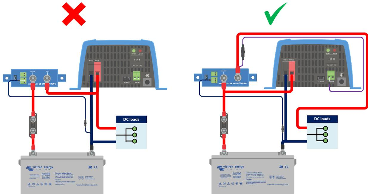
Imagen de la izquierda: Entrada CC del inversor conectada mediante un BatteryProtect - **estrictamente prohibido**
