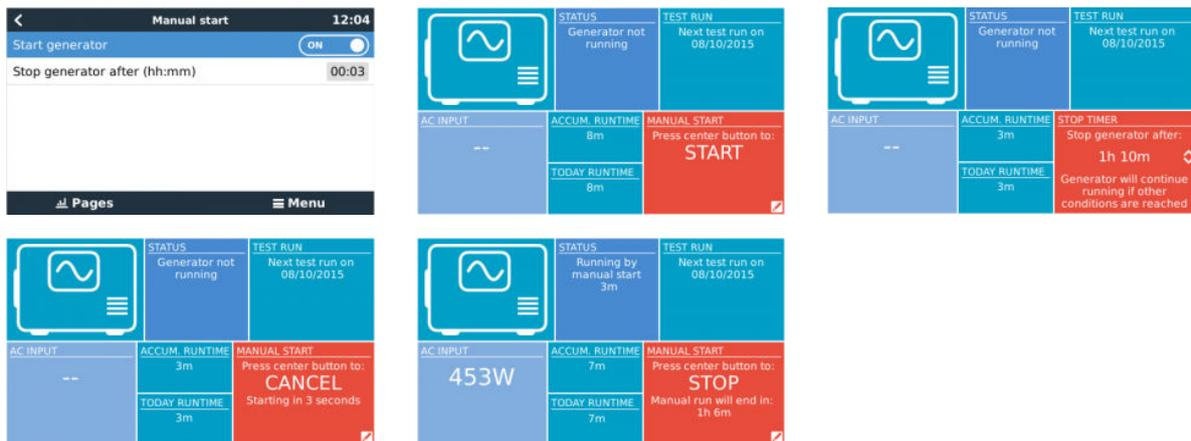
**ADVERTENCIA:** Si el generador se arranca manualmente (a distancia) sin el temporizador de parada, seguirá funcionando hasta que se accione manualmente el botón de “Off”.
