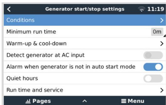
**Condiciones:** El menú de Condiciones determina cuándo debe el generador arrancar y detenerse automáticamente. Véase el capítulo [Condiciones: Parámetros que puede definir el usuario para que se active el arranque/parada automática del generador. \[134\]](#) para más información.
