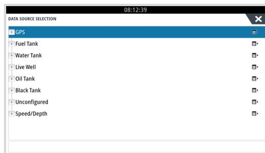
4. Al seleccionar un sensor de depósito desde el menú de Selección de la fuente de datos tendrá más detalles adicionales y opciones de configuración como tipo de líquido, ubicación o nombre personalizado. Por último, abra un panel de control o cree un panel de control personalizado y coloque los sensores del depósito como desee.
