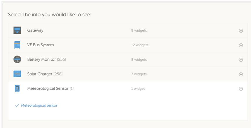
Los datos de los tipos de sensores disponibles aparecerán automáticamente en el gráfico. También se pueden habilitar y deshabilitar sensores o parámetros concretos pulsando en el nombre o la leyenda del sensor.
