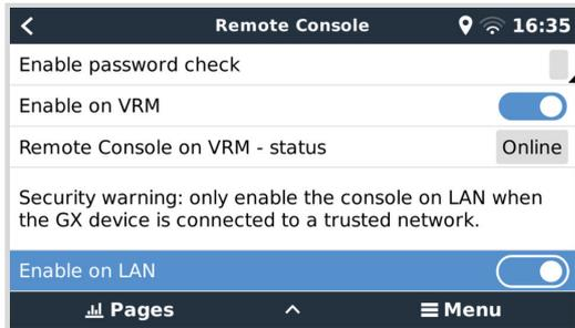
El menú Consola remota (Configuración → Consola remota) contiene opciones para controlar el acceso a la Consola remota mediante LAN/WiFi y VRM y muestra el estado online de la Consola remota en VRM.
