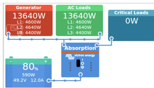
Mediante la integración del controlador del generador IntelliLite de la serie 4 de ComAp con un dispositivo GX, se pueden leer datos de CA, así como datos de presión del aceite, temperatura del refrigerante, nivel del depósito y otras lecturas relativas al estado. Además, acepta las señales digitales de arranque/parada del dispositivo GX.
