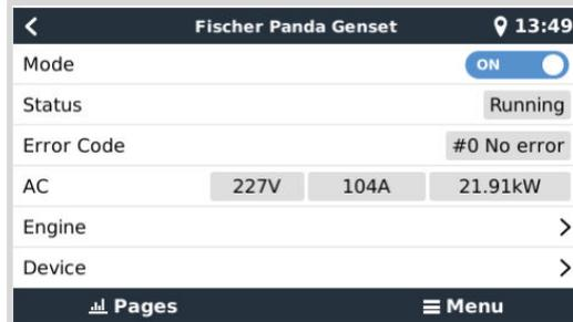
La temperatura del motor, las RPM y otros datos están disponibles en el submenú Motor (Engine).
