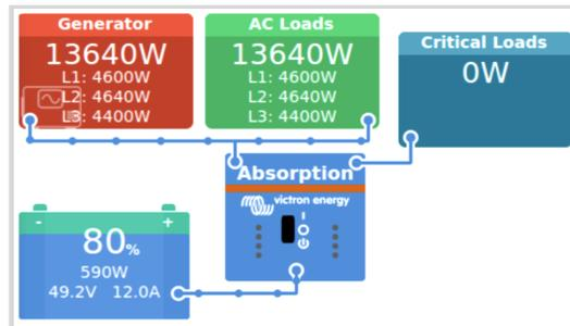
Mediante la integración de un controlador de generador Deep Sea Electronics (DSE) con un dispositivo GX, se pueden leer datos de CA, así como datos de presión del aceite, temperatura del refrigerante, nivel del depósito, número de arranques del motor y otras lecturas relativas al estado. Además, acepta las señales digitales de arranque/parada del dispositivo GX.
