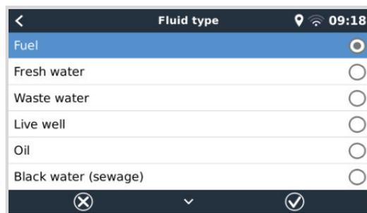
Esto se hace en el menú de configuración del sensor del depósito en la Consola remota - Lista de dispositivos → [su\_sensor\_de\_depósito] → Configuración → Tipo de líquido
