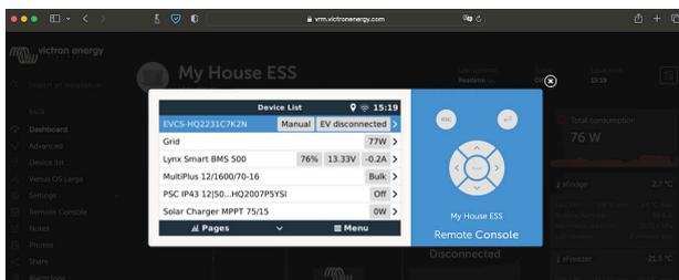
Este método requiere una conexión a Internet operativa, tanto en su teléfono, tableta u ordenador como para el Cerbo-S GX. Para una nueva instalación, esto significa que tiene que conectarse con un cable Ethernet.
