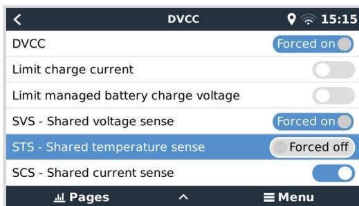
Seleccione el sensor de temperatura a usar y el dispositivo GX enviará la temperatura de la batería medida al sistema inversor/cargador y a todos los cargadores solares y cargadores de batería CC-CC Orion XS conectados.
