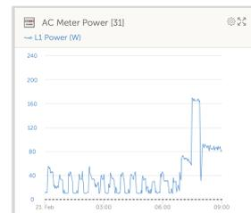
Todos los [tipos de contadores](#) pueden configurarse con la función de contador de CA. Esto se hace en Configuración → Contadores de energía → [su\_contador\_de\_energía] → Menú de la función, donde se elige entre red, inversor FV, generador y contador CA. Con contador CA seleccionado, la carga aparecerá en la lista de dispositivos y en los widgets avanzados de VRM.
