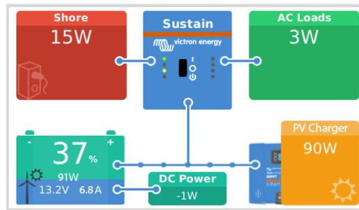
La función de dar prioridad a la energía solar y eólica garantiza que se usen energía solar y eólica para cargar la batería. Al mismo tiempo, la energía de la red solo se usa para evitar que la batería sufra una descarga demasiado profunda.
