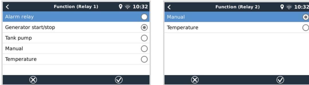
Si la función del relé se configura como relé de Alarma, es posible invertir la polaridad del relé mediante un menú adicional. El ajuste por defecto es Normalmente abierto. Tenga en cuenta que si se invierte la polaridad a Normalmente cerrado el consumo de corriente del dispositivo GX será ligeramente mayor.
