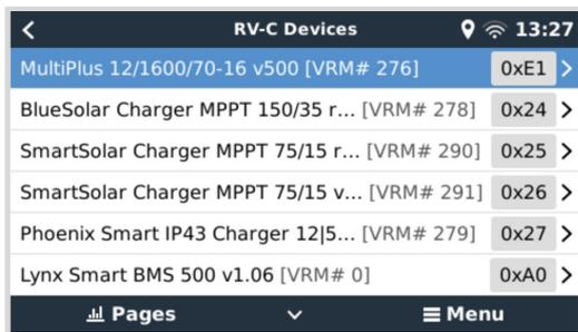
Cuando entre en el submenú de un dispositivo RV-C, verá la información general del dispositivo RV-C y, desplazándose hacia el final de la página, el menú de configuración. Para poder ver el menú de configuración se necesita tener acceso de usuario e instalador por lo menos. Véase el apartado [Estructura del menú y parámetros configurables](#).
