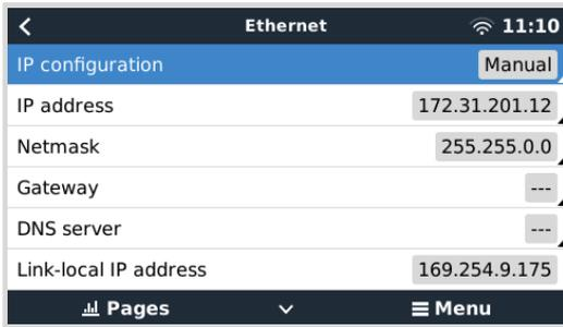
En el dispositivo Victron GX, asegúrese de que el cable Ethernet esté conectado y luego vaya a Configuración → Ethernet y haga los siguientes ajustes:
