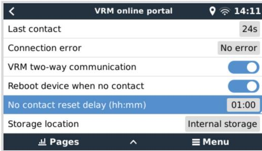
Esta opción, deshabilitada por defecto, hace que el dispositivo GX se reinicie automáticamente en caso de que no se haya podido conectar al portal VRM.
