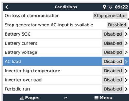
**Si se pierde la comunicación:** Si en alguna ocasión se rompe la comunicación entre el Cerbo-S GX y el inversor/cargador VE.Bus y se han establecido parámetros que dependen de esta información, elija entre las siguientes acciones:
