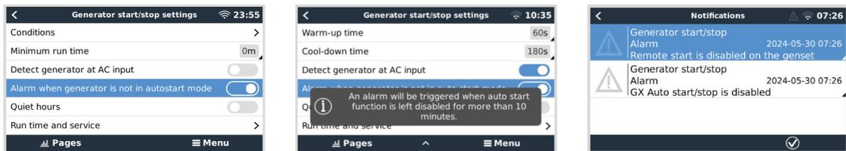
Si esta opción está habilitada, saltará una alarma cuando la función de arranque automático permanezca deshabilitada durante más de 10 minutos. Esto es especialmente útil cuando el generador se acaba de reparar y el técnico ha olvidado ponerlo de nuevo en modo de arranque automático.
