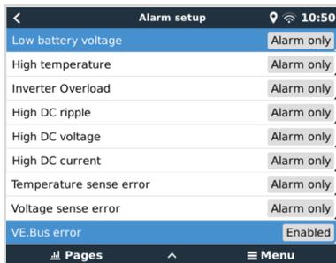
Cuando se usa un sistema VE.Bus, se puede configurar el nivel de gravedad de los problemas del sistema VE.Bus que debería mostrar una notificación en el Cerbo-S GX (y hacerlo pitar):
