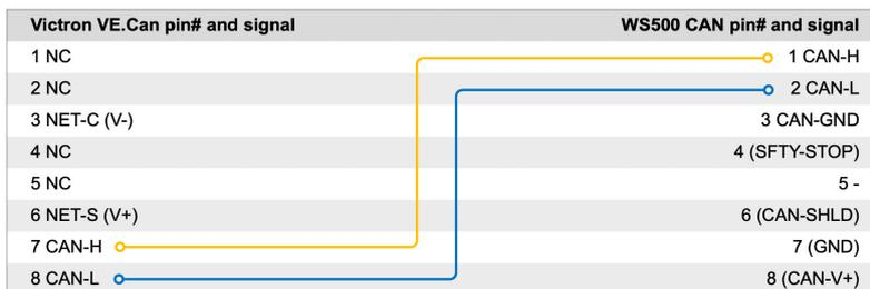
Los pines importantes a tener en cuenta son el 7 y el 8 para CAN-H y CAN-L en la parte VE.Can y el 1 y el 2 para CAN-H y CAN-L en la parte WS500.
