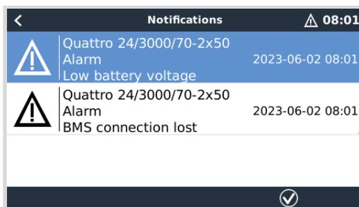
Esta alarma se dispara si el inversor/cargador recibe datos CVL/CCL o DCL de una batería gestionada y se apagará si la batería se desconecta o se pierde la comunicación con la batería. La alarma también salta si el inversor/cargador pierde la conexión con un VE.Bus BMS.
