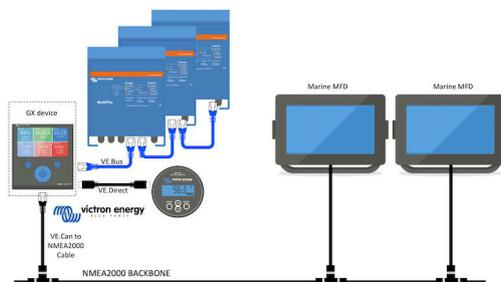
Los dispositivos GX de Victron Energy cuentan con una función de salida NMEA 2000. Si está habilitada, el dispositivo GX actúa como un puente: hace que todos los monitores de baterías, inversores/cargadores y demás productos conectados al dispositivo GX estén disponibles en la red NMEA 2000.
