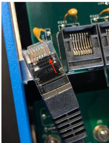
El inconveniente de cortar el pin 7 es que apagar el dispositivo VE.Bus será menos eficaz: aunque dejará de cargar e invertirá, seguirá en modo reposo y por lo tanto extraerá más corriente de la batería que si se hubiera dejado el pin 7. Normalmente, esto solo es relevante en sistemas marino o de automoción, en los que es habitual apagar el dispositivo VE.Bus regularmente. En estos sistemas, le recomendamos que no corte el pin 7 y que simplemente alimente el Cerbo-S GX desde la batería.
