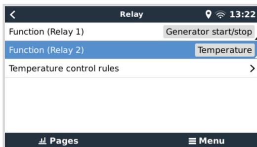
Se puede usar cada sensor de temperatura para controlar el relé. Seleccione el sensor de temperatura que quiere usar para controlar el relé. Los sensores de temperatura que no se usen mostrarán el mensaje “No actions” (Sin acciones). Desde este menú se puede habilitar o deshabilitar el control del relé de temperatura de cada sensor de temperatura.
