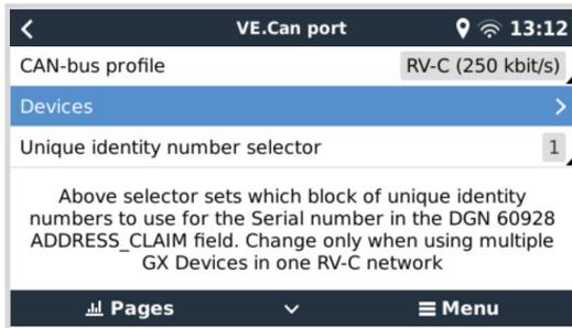
Los dispositivos con RV-C out pueden configurarse desde el submenú Dispositivos del menú del Puerto VE.Can.
