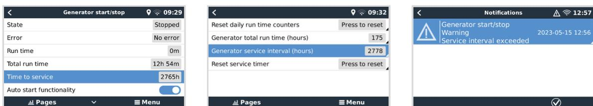
Todos los generadores necesitan tareas de mantenimiento tras un determinado periodo de tiempo. La frecuencia recomendada del mantenimiento de un generador depende en particular de su uso y su tiempo de funcionamiento. Este intervalo de tiempo puede fijarse a través de este menú, que luego inicia un contador que, una vez cumplido el plazo, genera un aviso para indicar que hace falta mantenimiento.
