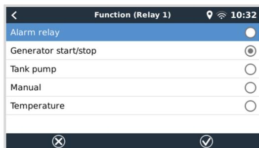
Una vez activada esta función, podrá encontrar todos los ajustes relativos a la función arranque/parada automática del generador en el menú principal en: Configuración → Arranque/parada del generador.
