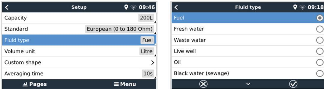
Esto se hace en el menú de configuración del sensor del depósito en la Consola remota - Lista de dispositivos → [su\_sensor\_de\_depósito] → Configuración → Tipo de líquido
