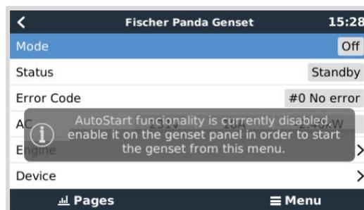
Si el arranque/parada automático del generador está habilitado, aparecerá el error n.º 1: Control mediante interruptor remoto deshabilitado en la página de arranque/parada automático.
