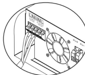
4. A continuación, inserte los cables de salida de corriente alterna de acuerdo con polaridades indicadas en el bloque terminal y apriete los tornillos terminales.
