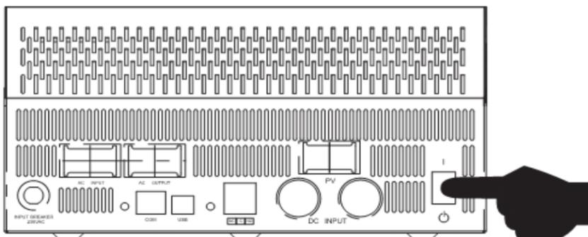
Una vez que la unidad se ha instalado correctamente y las baterías están bien conectadas, sólo tiene que pulsar el interruptor de Encendido/Apagado (que se encuentra en la parte inferior del gabinete) para encender la unidad.
