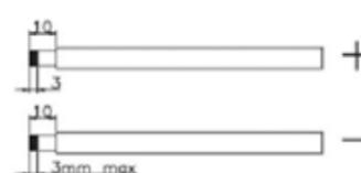
módulos fotovoltaicos y los conectores entrada FV. Luego, conecte el polo positivo (+) del cable de conexión al polo positivo (+) del conector de entrada FV. Conecte el polo negativo (-) del cable de conexión al polo negativo (-) del conector de entrada FV.
