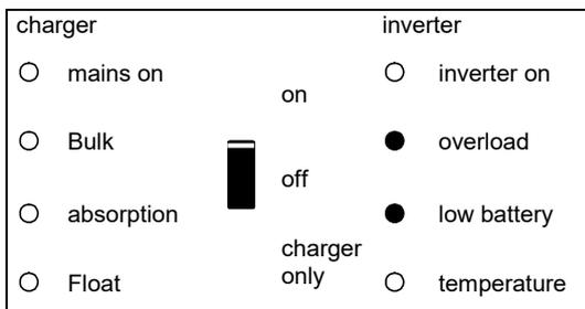
De omvormer is uitgeschakeld door een veel te hoge rimpelspanning bij de accu-aansluiting.
