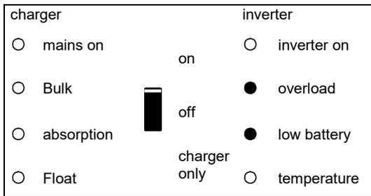
Le convertisseur s'est arrêté parce que la tension d'ondulation est trop élevée sur la connexion de la batterie.
