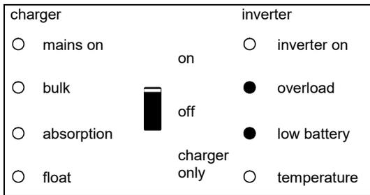
Der Wechselrichter ist wegen zu hoher Brummspannung am Batterieanschluss ausgeschaltet.
