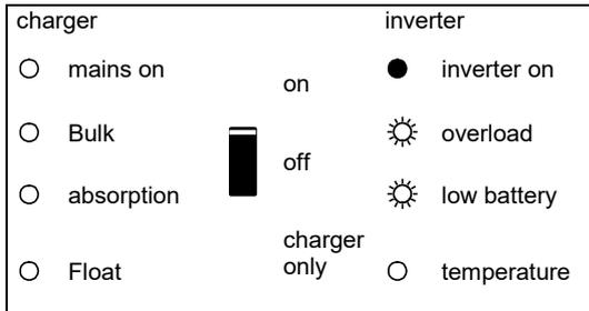
– Als de leds afwisselend knipperen, is de accu bijna leeg en is het nominaal vermogen overschreden.
