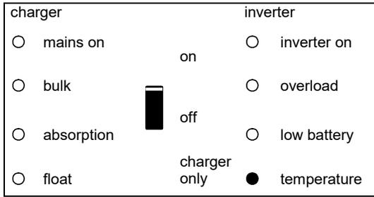
Der Wechselrichter ist wegen zu hoher Betriebstemperatur abgeschaltet.
