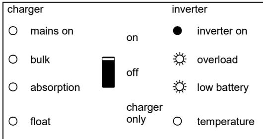
– A lampeggio alternato dei LED corrispondono gli stati di batteria quasi scarica e superamento della potenza nominale.
