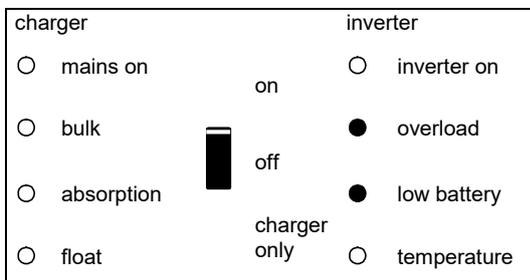
El inversor se para debido al exceso de tensión de ondulación en la conexión de la batería.
